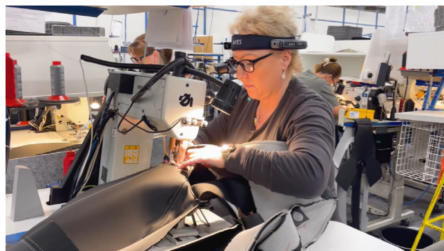
Na displeji brýlí se zobrazují jednotlivé pracovní postupy, které navádí pracovníka krok po kroku k jejich splnění.
